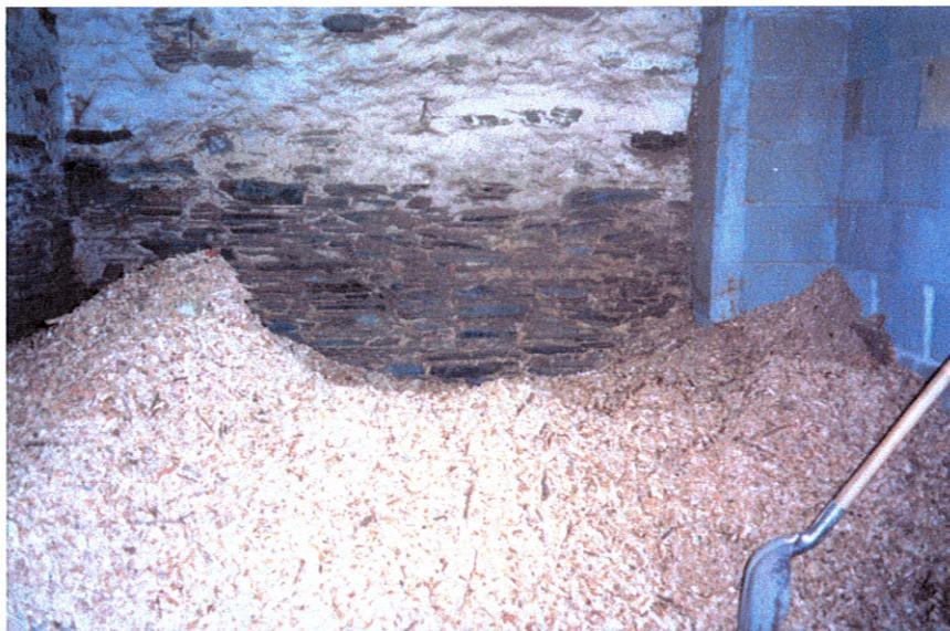
Cette opération consiste à ramener l'humidité des plaquettes à un taux correspondant au cahier des charges de l'exploitant de la chaufferie (souvent 25 %).
